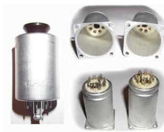
Рис.3 Лампа 12Ж1 и панельки к ней.
