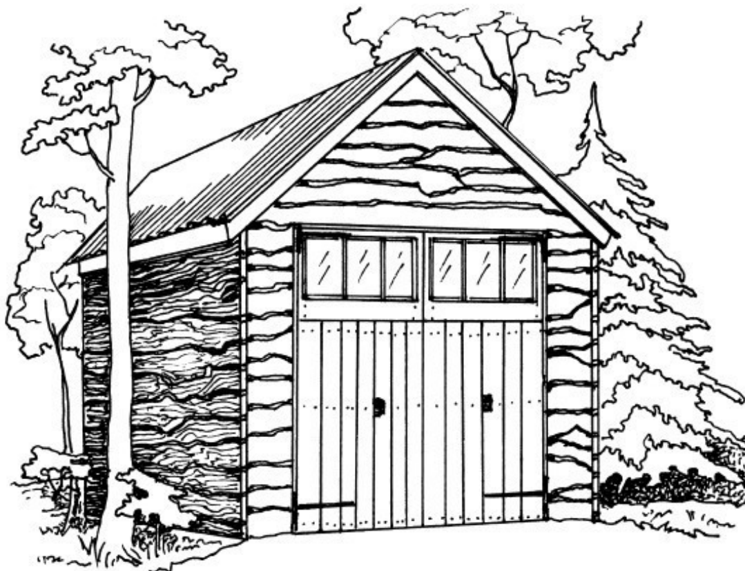
Рисунок 6. Гараж из необрезных досок, обработанных огнестойким составом, с 2-скатной крышей и деревянными распашными воротами
