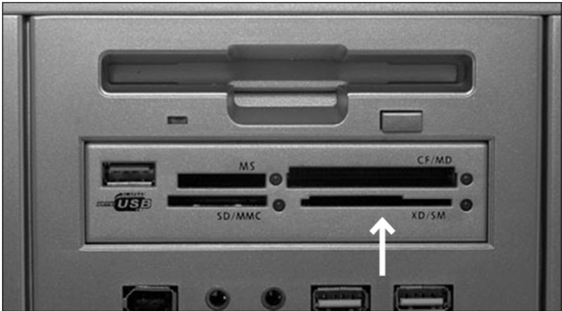
Разъемы для разных карт памяти на передней панели системного блока компьютера
