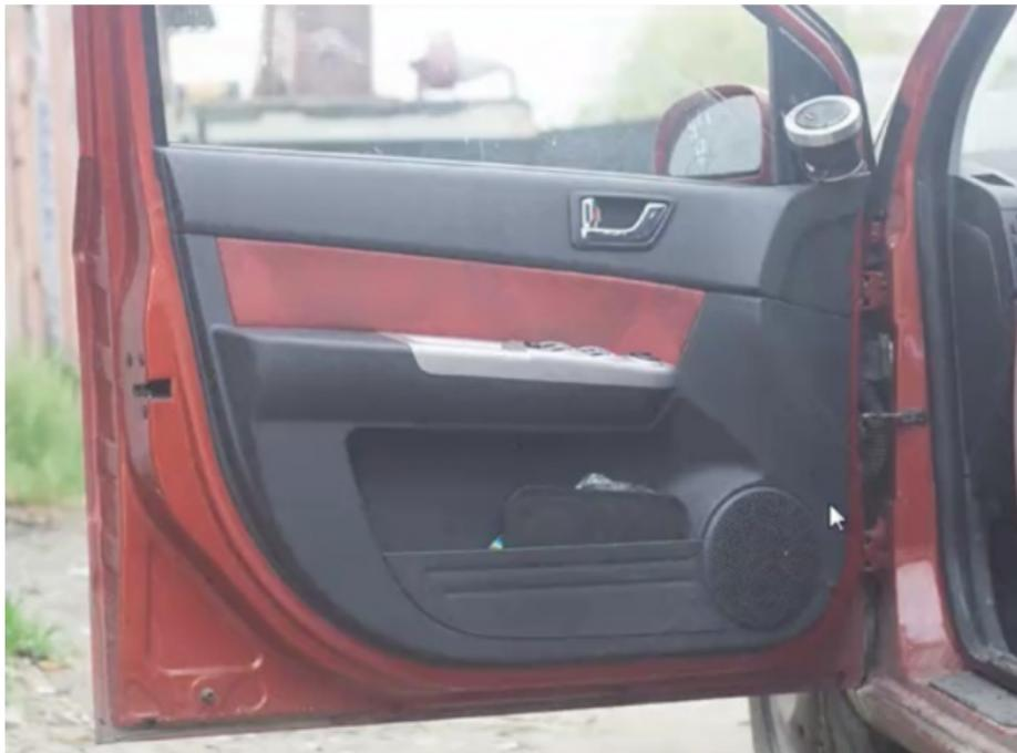
*Сергей: Я имею в виду, полная переделка обшивки? На «Гетце» она разбираемая, так как состоит из отдельных частей. В процессе работы некоторые части отделяются, в одну из них без проблем интегрируется подиум. Блок управления зеркалом есть на обшивке, и здесь достаточно крупное место, то есть тут спокойно можно сделать подиум. У «Гетца» также достаточно глубокое место в багажнике, сюда можно много всего поместить, фальшполы и прочее.*
