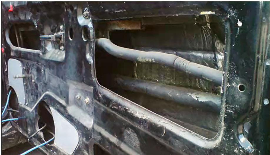
*Шумоизоляцию двери мы делаем в несколько слоев. На внешнюю филенку двери монтируем слой виброизоляции. Это может быть «вибропласт» или «бимаст», наклеенный сплошным слоем, или полосками крест-накрест. Если вы экономите материал, можно таким образом обработать внутреннюю часть двери.*
