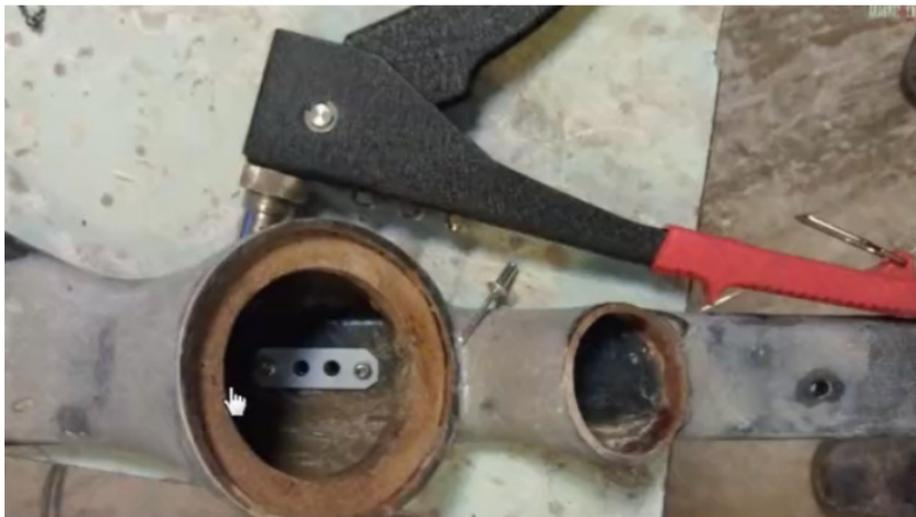
Дальше, внутри стойки, видим крепежные элементы, чтобы крепить стойку к металлу.
