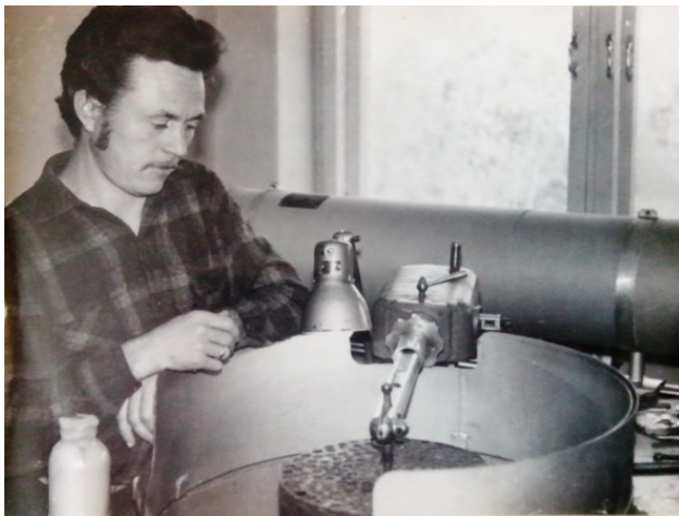
Фото 10. Вакуумный напылитель оптики РР-500.
