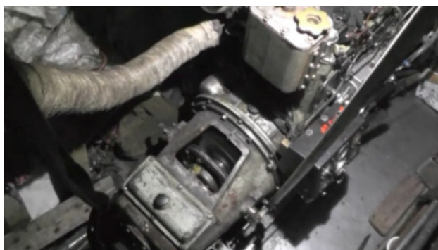
Проклятый редуктор РРП-40-3 без крышки
