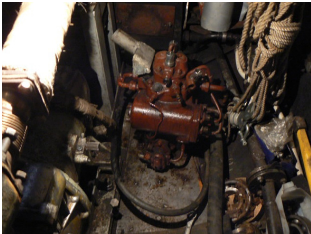
Компрессор (200 атм.) с фильтрами для забивки ак- валангов и носовые каюты
