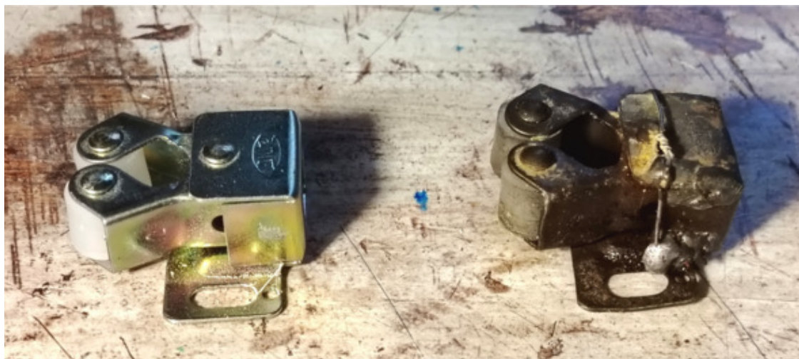
Пример маразма и нищеты 90-х годов: ремонт пайкой мебельной защелки.
