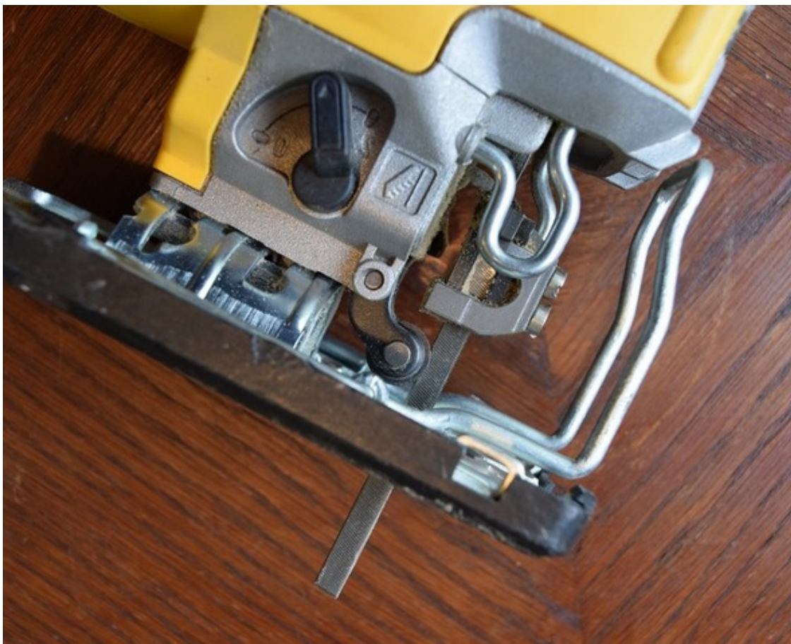
В электролобзик вставлен обточенный на наждаке надфиль.
