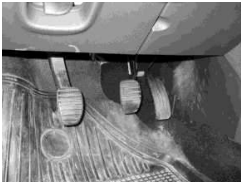
Рис. 1.3. Педали сцепления, тормоза и газа
