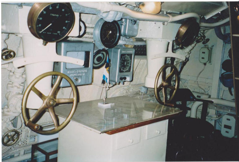
Пост управления горизонтальными рулями (фото автора)
