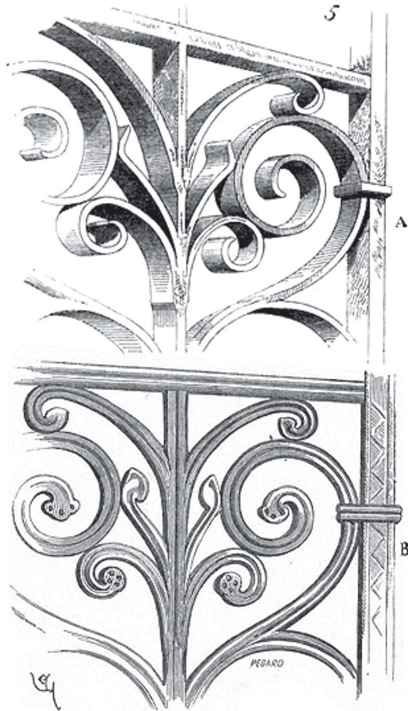
La fig. 5, qui donne le même dessin de grille, l'un, celui A, obtenu avec des fers de champ, l'autre, celui B, avec des fers de plat, fera comprendre cette loi si simple et si peu observée
