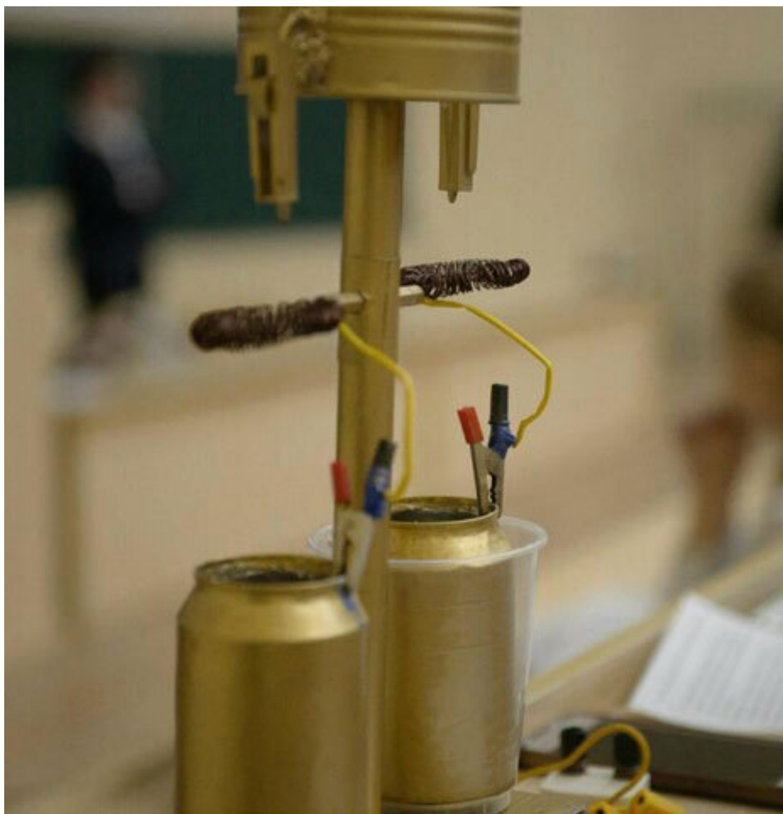
Рисунок 2 – Медные кольца, как оптимальный вариант для работы модели генератора
