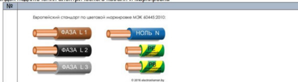
Порядок подключения электрического кабеля и маркировка
