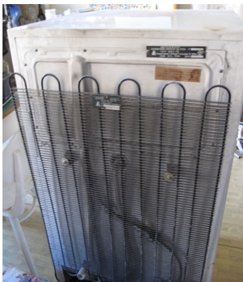
Рис. 2. Конденсатор на задней стенке холодильника
