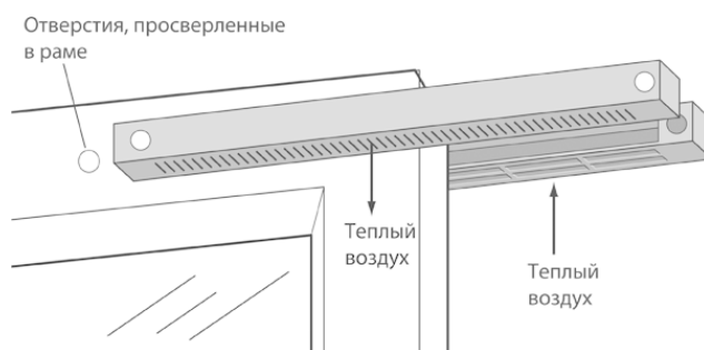
Рис. 2.1. Оконный вентиляционный клапан перед установкой в верхней части окна.
