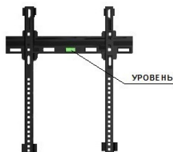
Рис.16. Панель крепления телевизора с уровнем
