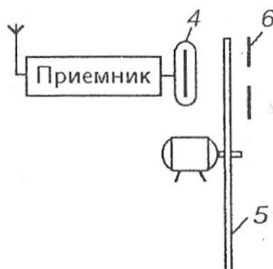
Рис. 3. Приемная часть системы Нипкова
