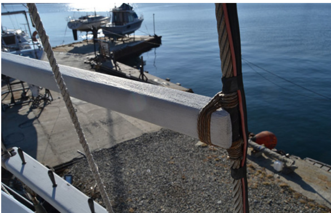
Балясины установлены на вантах обеих мачт правого борта
