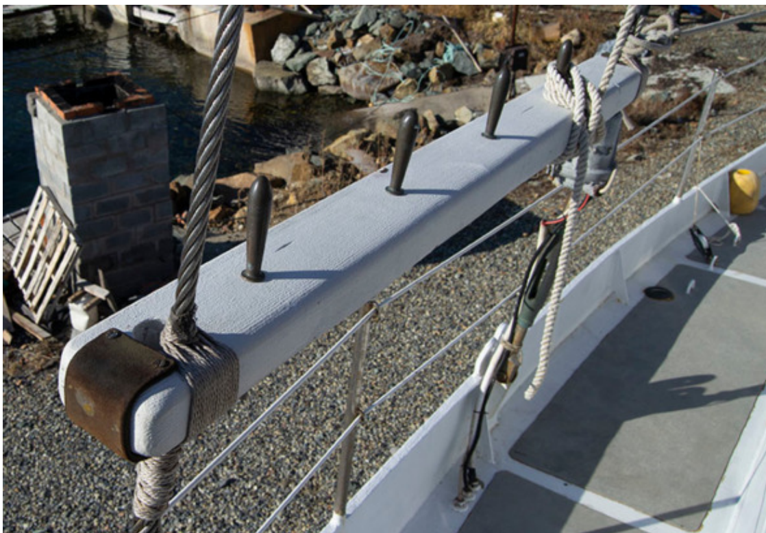
Кофель-планки закреплены на вантах бензелями
