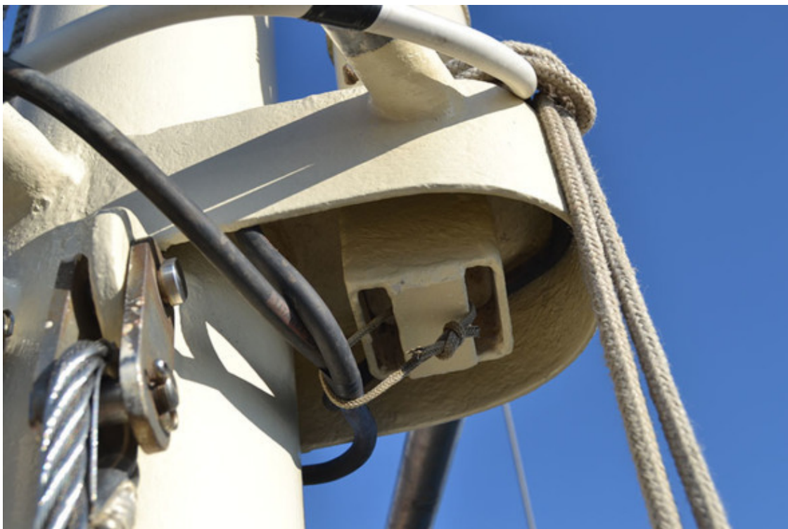
Вид на салинг со степсом стены, краспицы и верхний узел крепления грота-ванты
