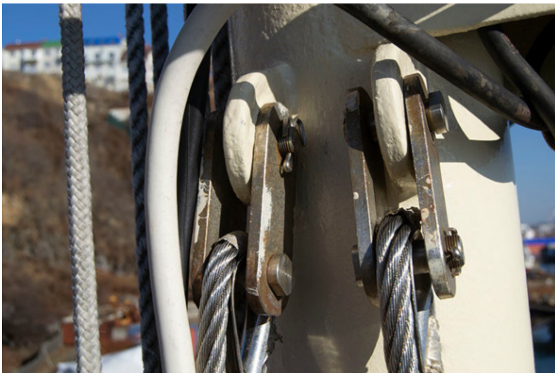
Верхние вантовые огоны крепятся к мачте через проставки с двумя щечками и пальцами. Пластина крепления на мачте сплошная, проходит насквозь, и используется для пары вант
