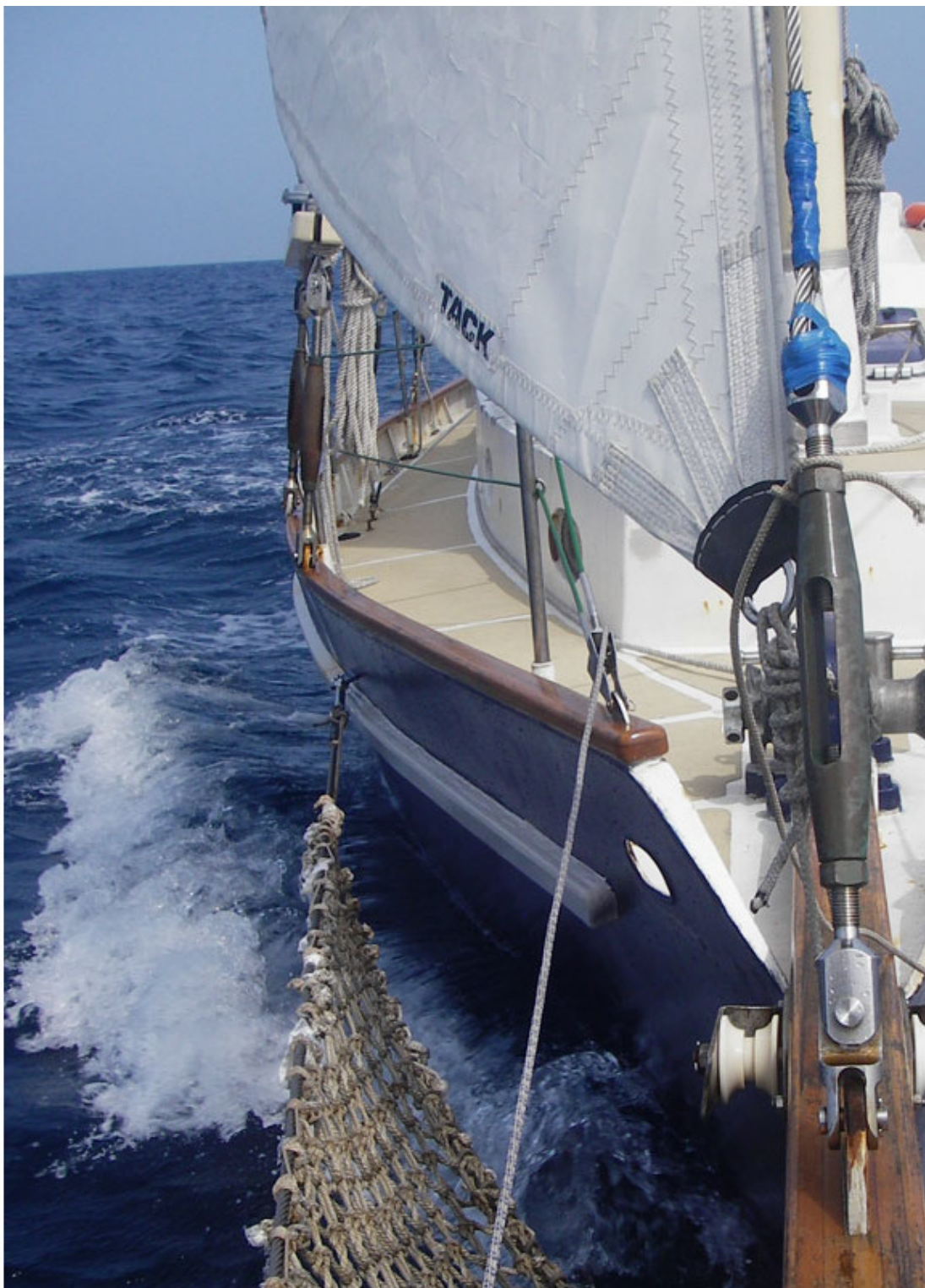
Нижний огон тросов стоячего такелажа заканчивается самодельным талрепом.
