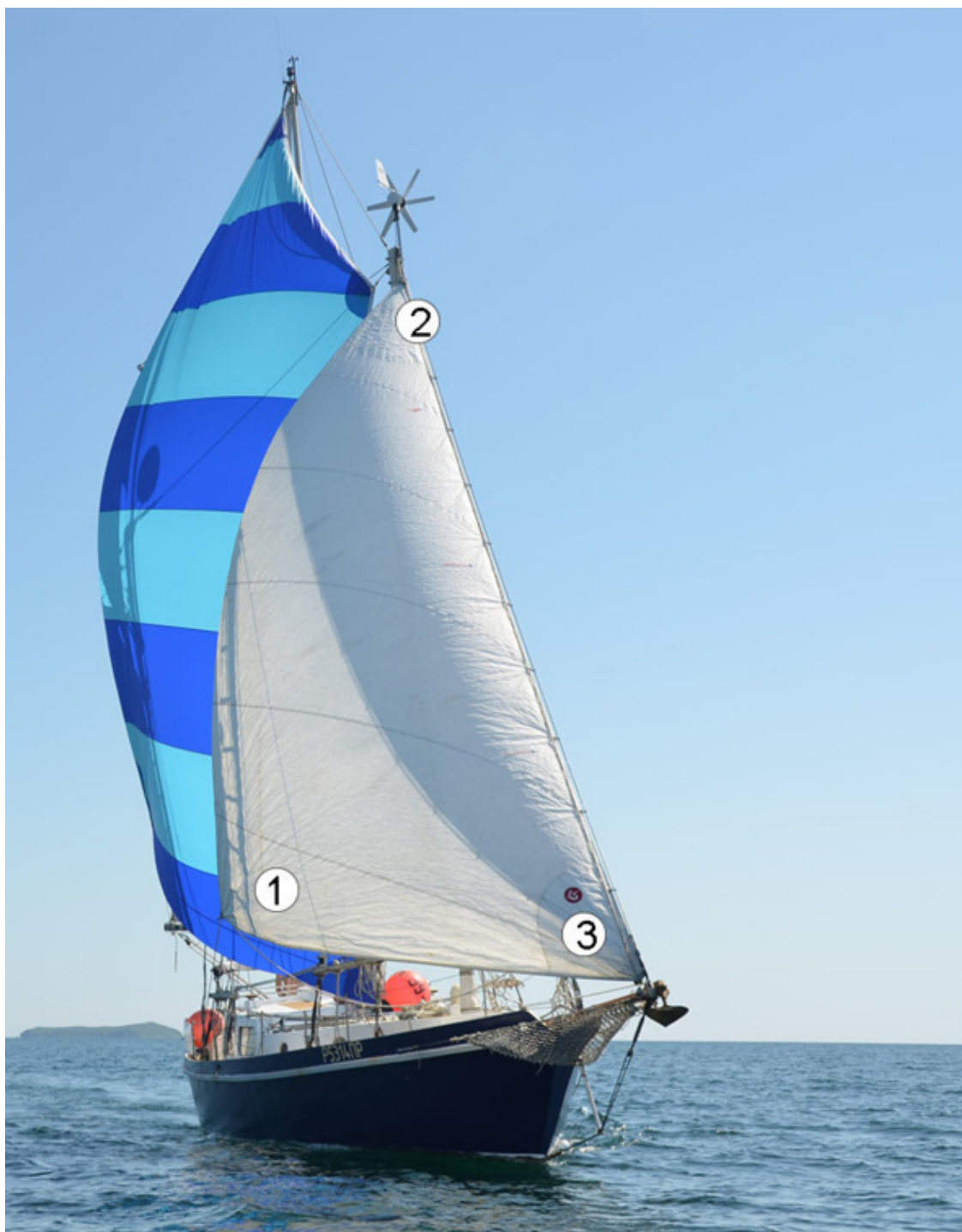
Треугольный парус (генуя): 1 – шкотовый угол, 2 – фаловый угол, 3 – галсовый угол
