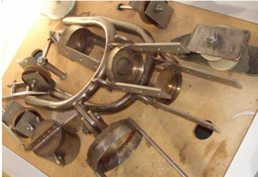
Детали рангоута, подготовленные к установке.
