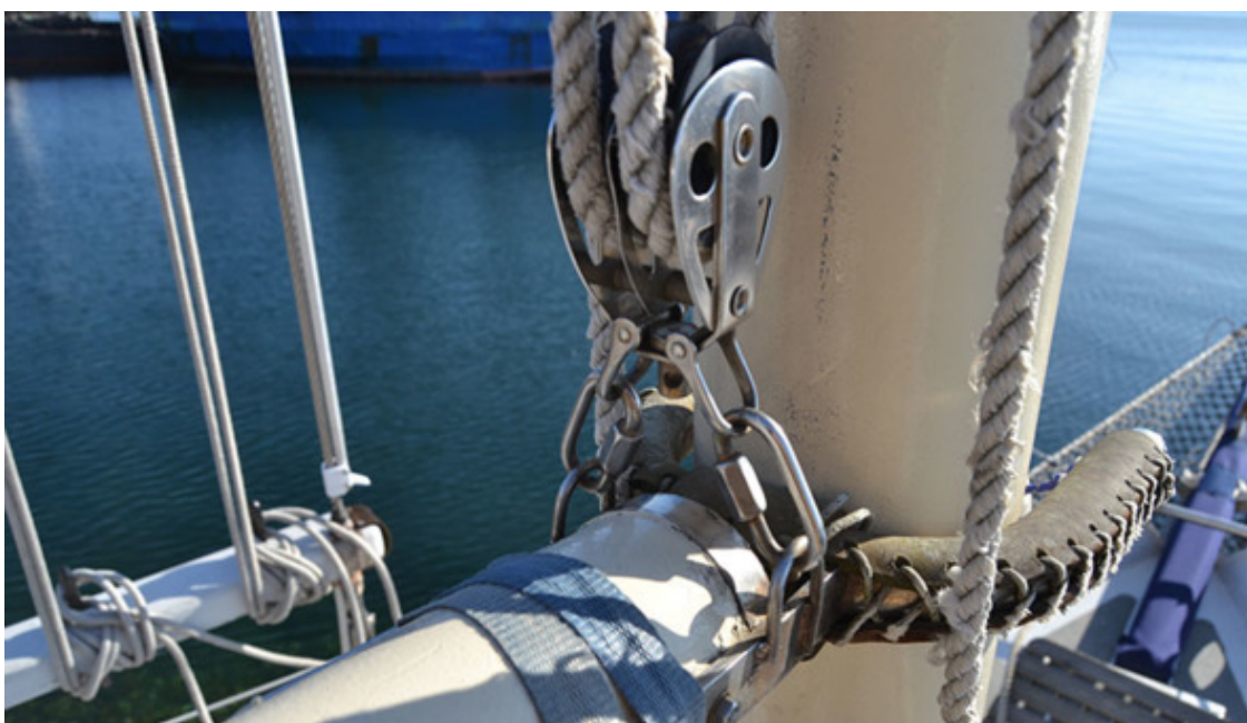
Крепление нижнего блока гафель-гардели к гафелю. Усы гафеля обшиты технической кожей. Гафель у мачты удерживается ракс-клотами, замыкающими усы.
