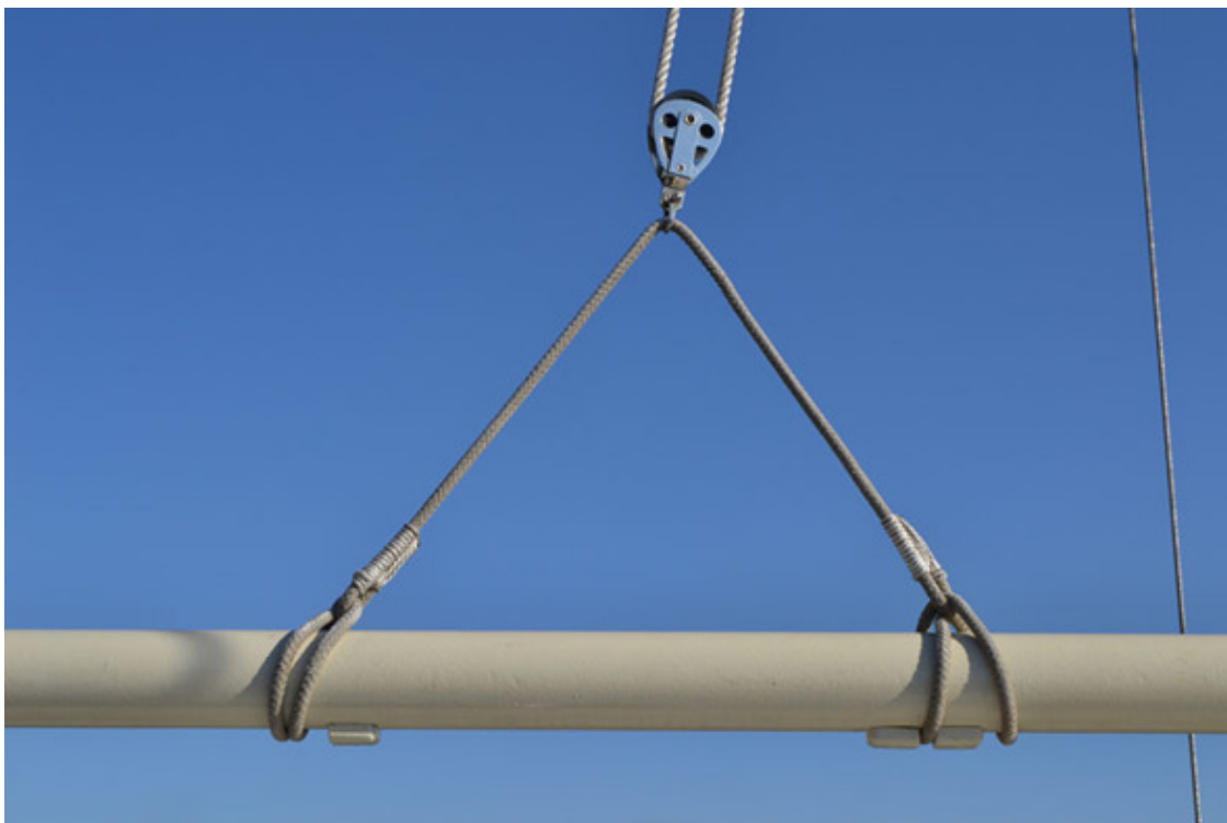
Крепление нижних блоков дирик-фала на гафеле
