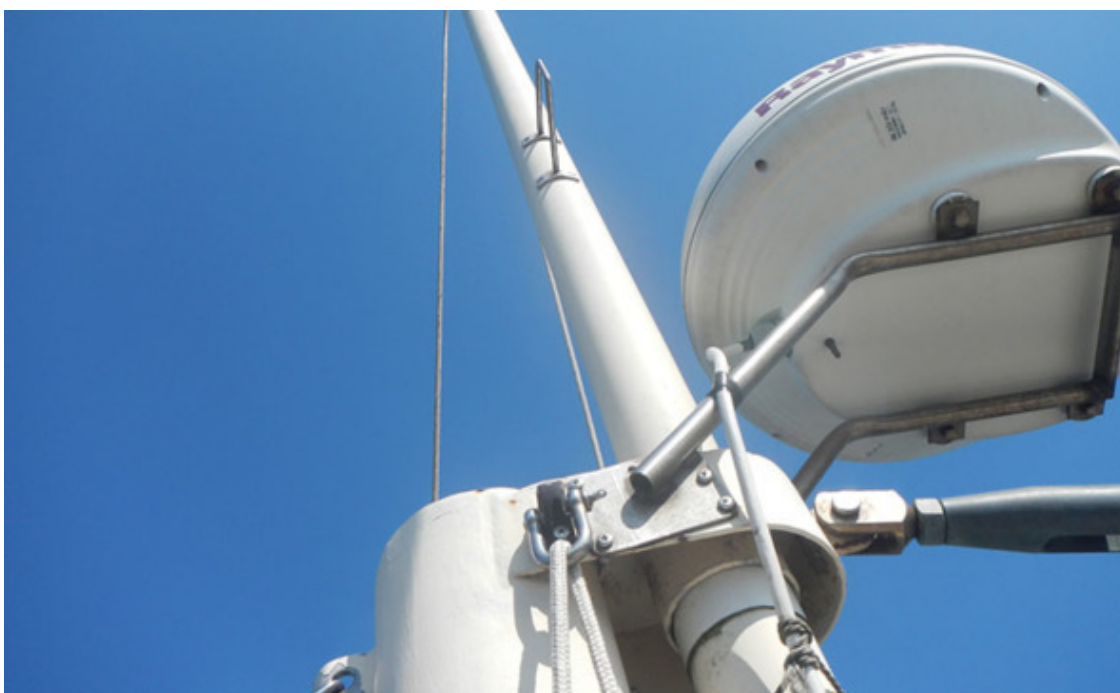
Эзельгофт. Стеньга проходит через него и своим шпором вставлена в степс на салинге.
