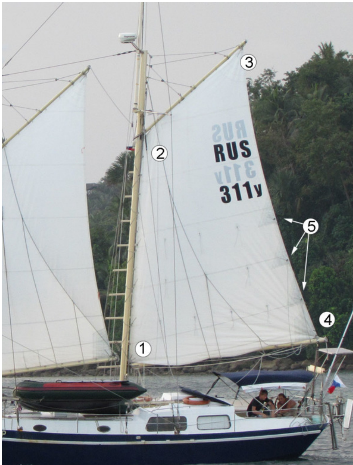
Гафельный парус (грот шхуны): 1 – нижний галсовый угол, 2 – верхний галсовый угол, 3 – нок-бензельный угол, 4 – шкотовый угол, 5 – три полки рифов
