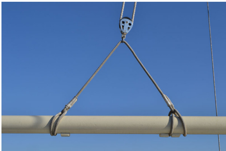
Крепление нижних блоков дирик-фала на гафеле
