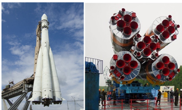
Рис. 9. Ракета-носитель «Восток». Пакеты двигателей.
