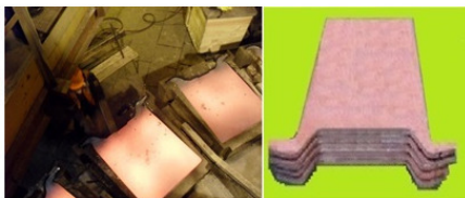
Рис. 3. Разливка анодов. Медные аноды на складе
