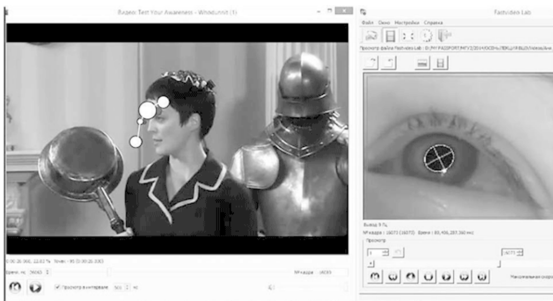
Рис. 5. Синхронный вывод трека в интервале 500 мс и видеоизображения глаза, которое хранится в отдельном файле
