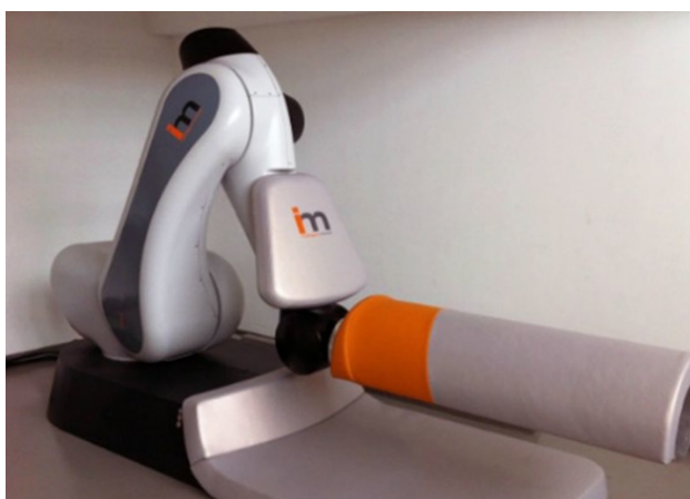
Рисунок 9. Роботизированный комплекс для иппотерапии «Hirob»
