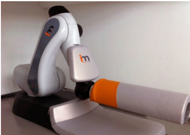
Рисунок 9. Роботизированный комплекс для иппотерапии «Hirob»
