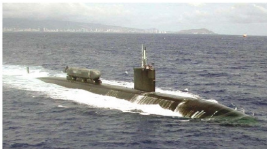
Рис. 3. Сверхмалая подводная лодка ASDS (США) на борту ПЛ «Гринвилл».
