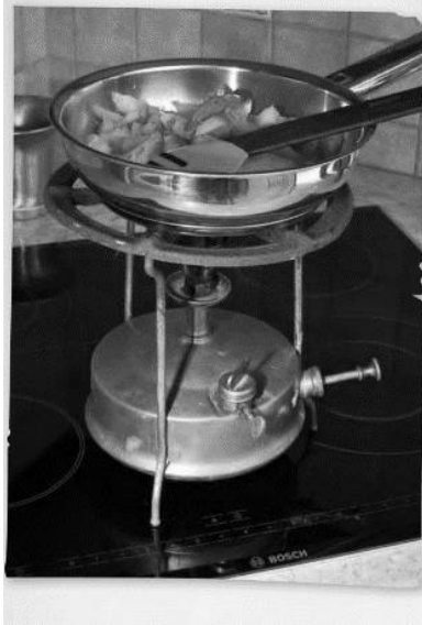
Примус обыкновенный (общий вид) с «шумной» горелкой: 1 – резервуар; 2 – днище; 3 – трубка насоса; 4 – крышка насоса; 5 – шток насоса; 6 – гайка насоса; 7 – кожаный манжет насоса; 8 – клапан насоса; 9 – корпус наливного люка; 10 – крышка наливного люка; 11 – воздушный винт; 12 – трубка воздушного винта; 13 – штуцер; 14 – гайка горелки; 15 – трубчатая часть горелки; 16 – испарительная камера; 17 – чашечка; 18 – упорное кольцо; 19 – отражатель; 20 – форсунка (капсюль, ниппель)
