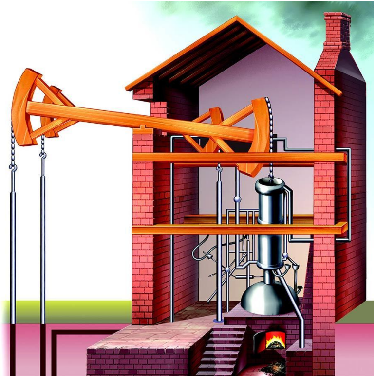
Паровая машина Томаса Ньюкомена
