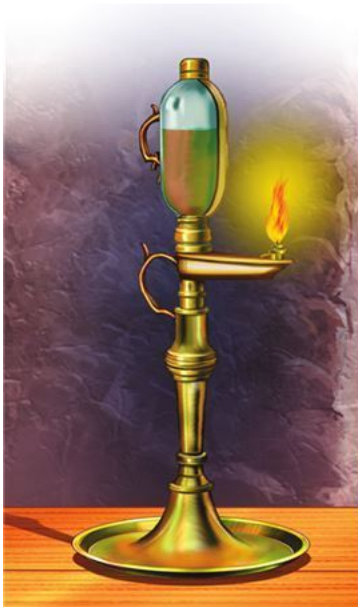
В лампах-часах время определялось по уровню еще не сгоревшего масла
