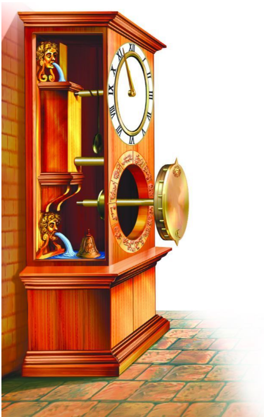
Автоматические водяные часы с круглым циферблатом и часовой стрелкой
