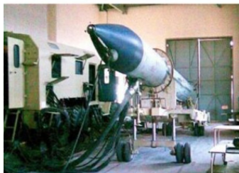
Зенитная управляемая ракета 5В28 системы С-200В
