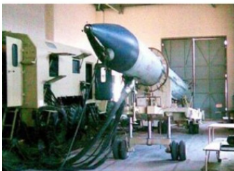
Зенитная управляемая ракета 5В28 системы С-200В
