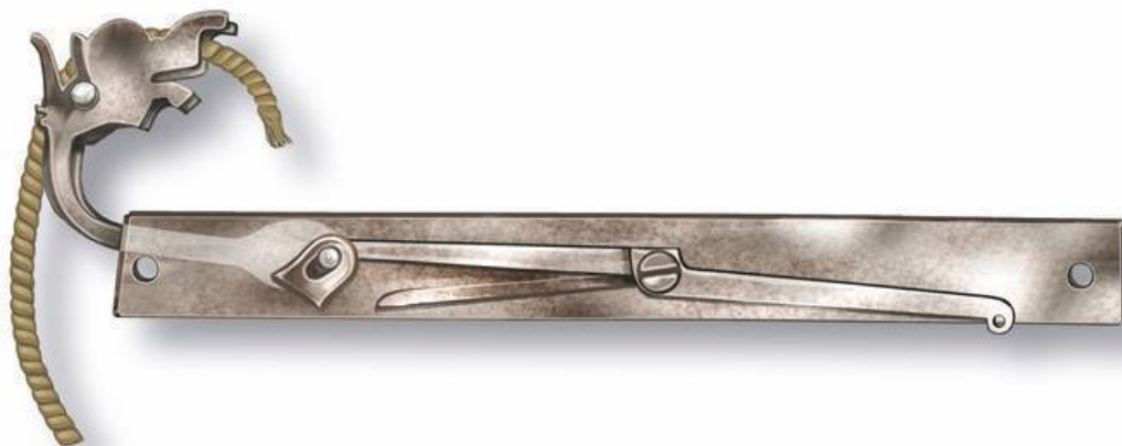
Нехитрое устройство фитильного замка
