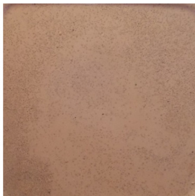
Zdjęcie 9. Odlew z mieszanki tynkowej z dodatkiem nie tak drobnego piasku (widok z dołu). Małe frakcje są zbierane w środku, na przecięciu linii ukośnych. Wiedząc, że w pewnych warunkach słaby punkt tworzy się w środku rzutu, może być pomocny.
