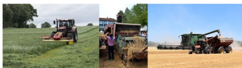
Рисунок 13. Косилка и молотилка были объединены в комбайн
