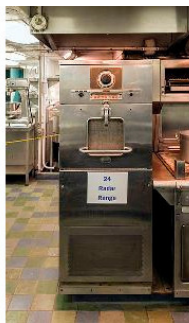
Рисунок 19. Первая серийная микроволновая печь весила 340 килограмм и использовалась в ресторанах
