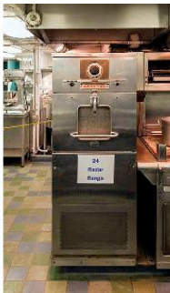
Рисунок 12. Первая серийная микроволновая печь весила 340 килограмм и использовалась в ресторанах
