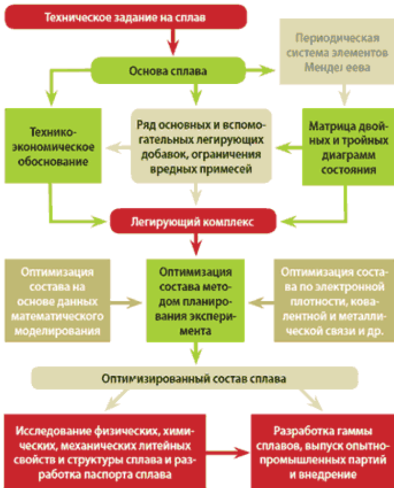
Рис. 1.1. Схема выбора состава литых сталей
