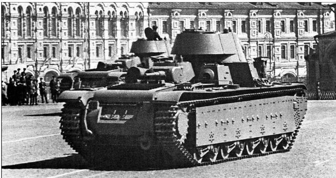
Танки Т-35 позднего выпуска (с коническими башнями)
