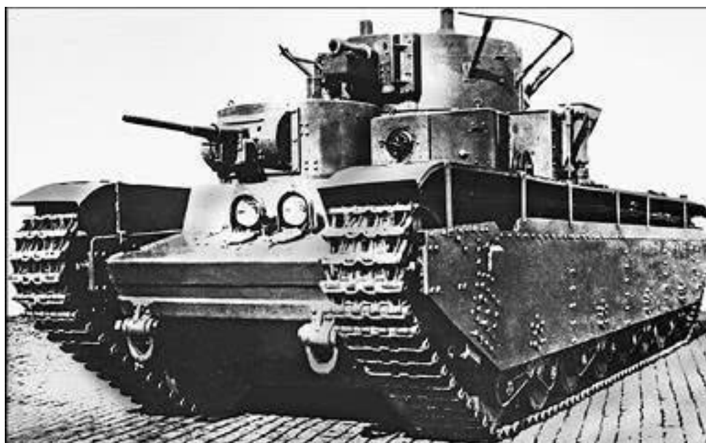
Тяжелый танк Т-35 первых серий
