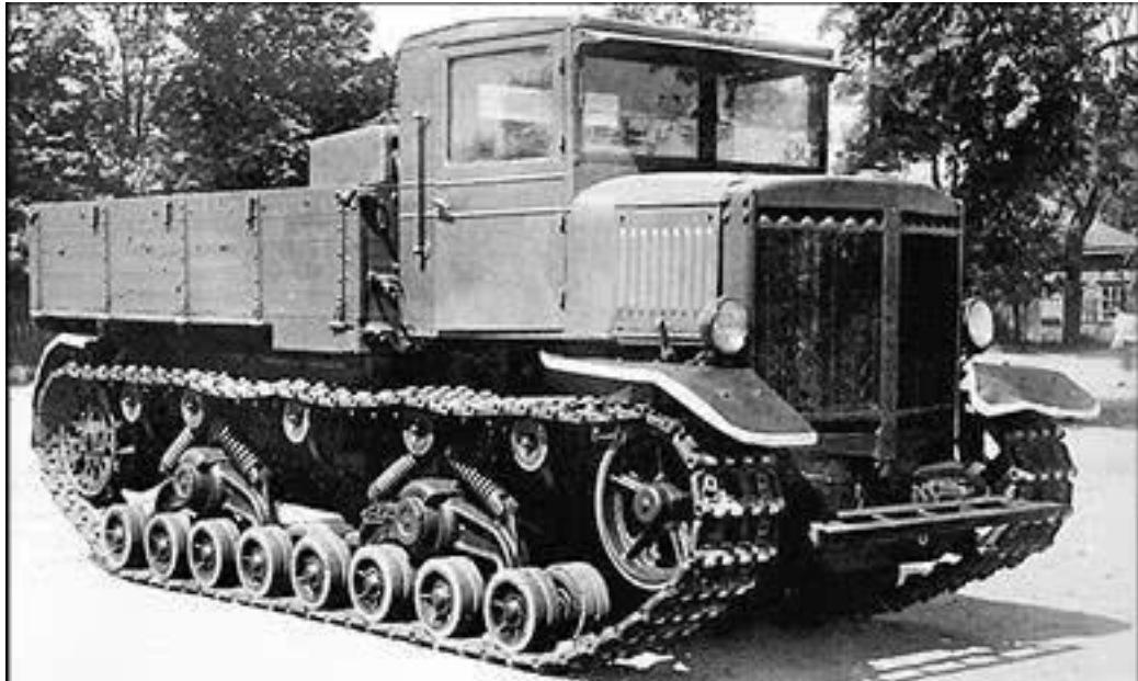
Тяжелый артиллерийский тягач «Ворошиловец»
