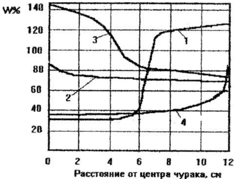
Рис. 3.3. Образование разброса влажности в березовом чураче. 1- сосна, 2- береза без ложного ядра, 3-береза с ложным ядром, 4-лиственница.
