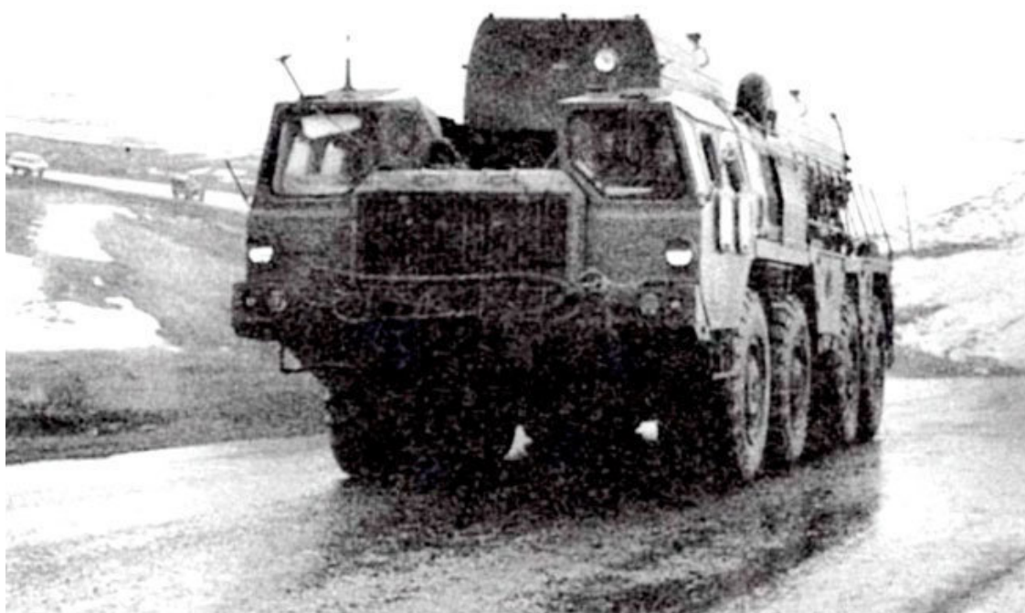
Транспортная машина 9Т219 с контейнером, 1987–1988 г.г. (NBI 1987–1988 г.г.)
