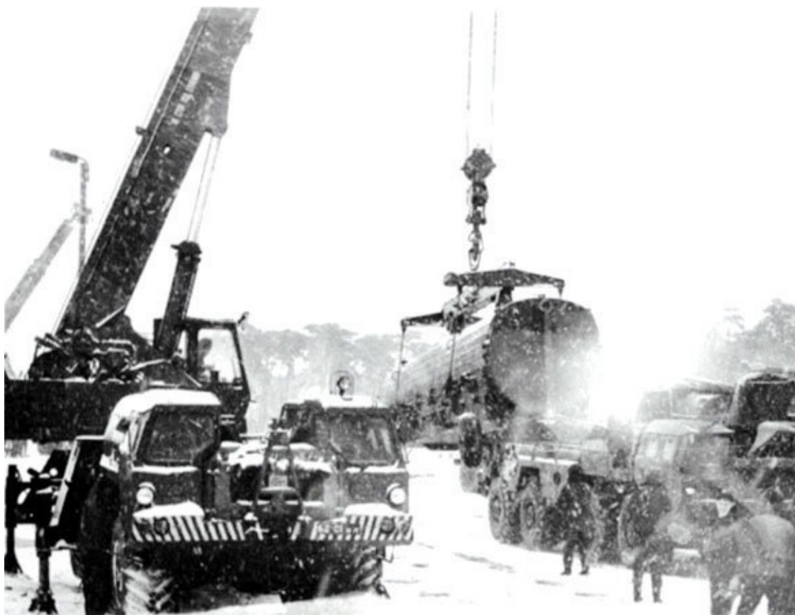
Кран на шасси МАЗ-543 осуществляет погрузку контейнера с ракетой на транспортную машину 9Т219 (фото с сайта http://forum.11td.ru ).
