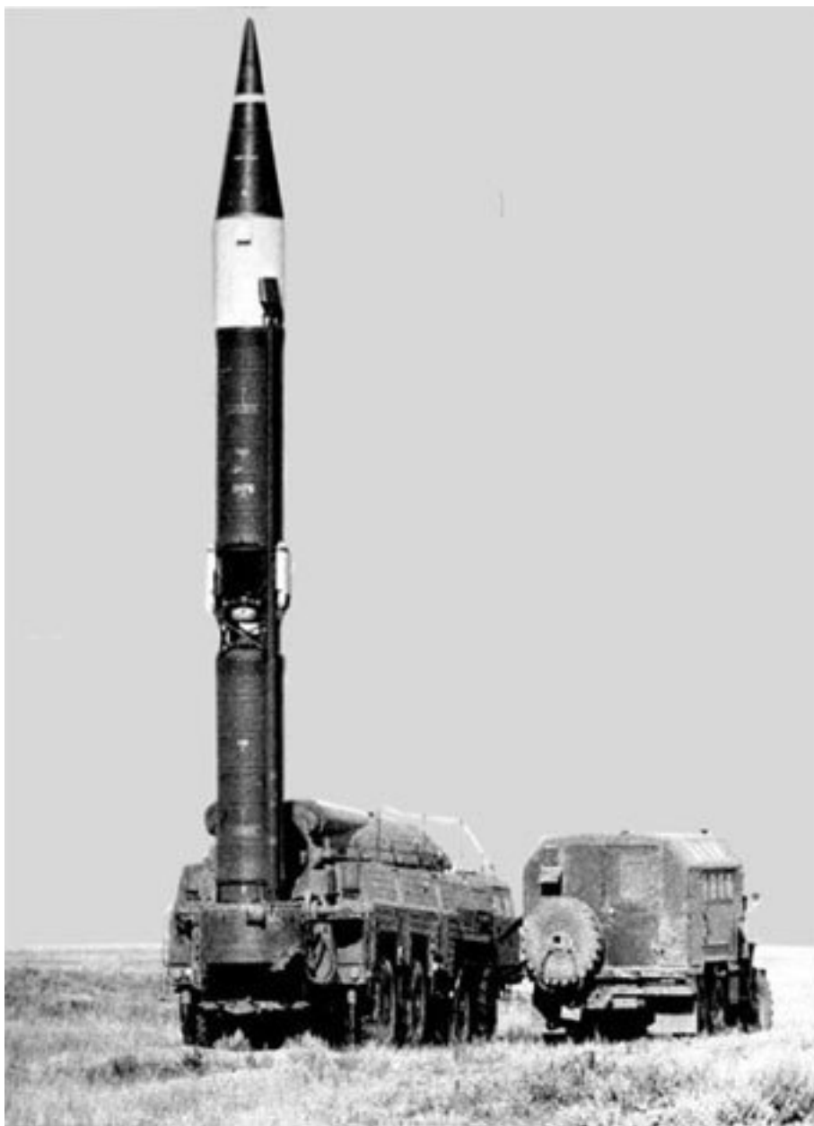
Комплекс 9К76 «Темп-С» – СПУ 9П120 и машина испытаний и пуска ("60 лет в строю полигон Капустин Яр. 1946–2006 г.г., ГЦМП "Капустин Яр", 2006 г.).
