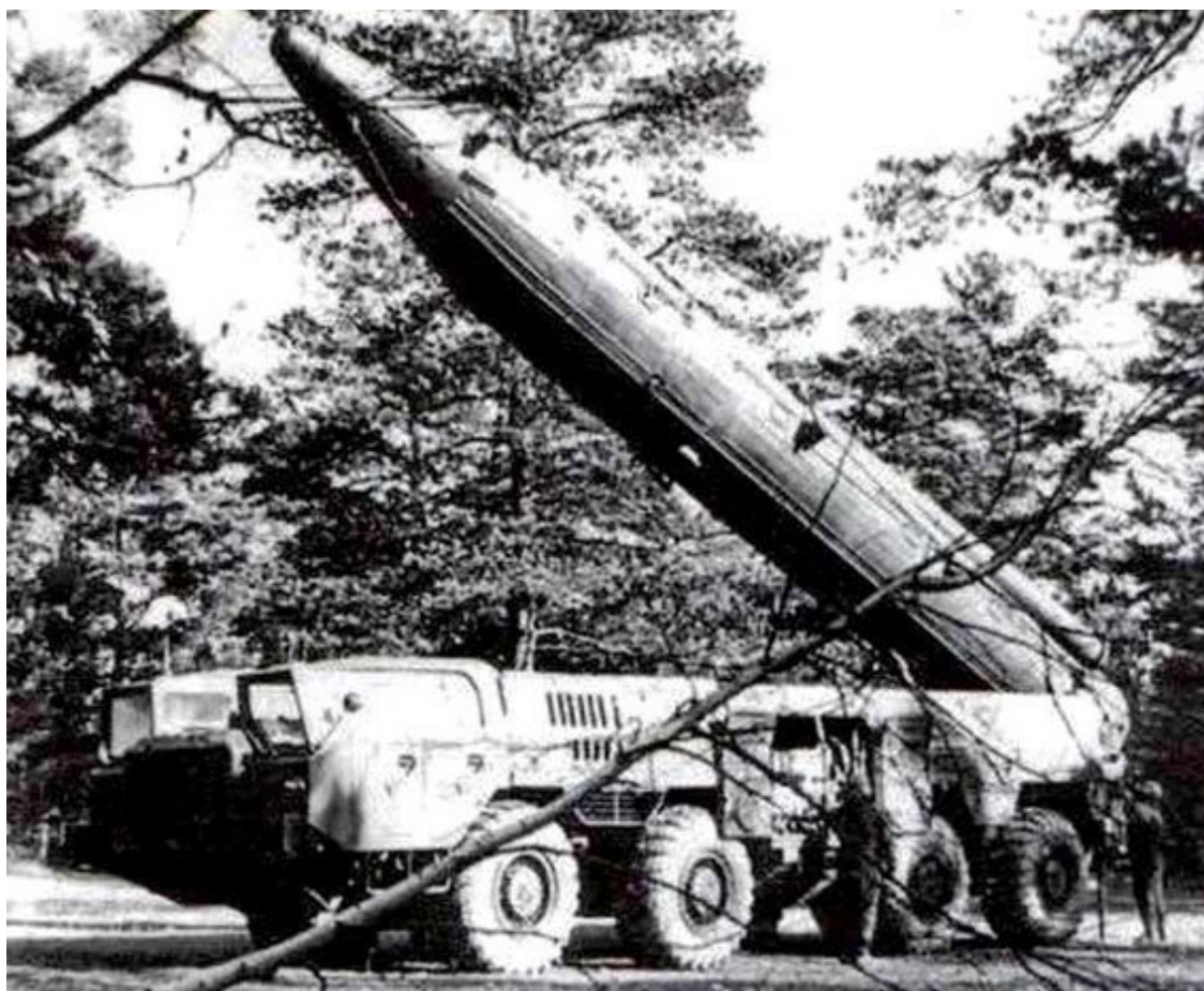
СПУ 9П120 комплекса 9К76 «Темп-С» – первый этап подготовки ракеты к старту – подъем ракеты в защитном контейнере 9Я230 в стартовую позицию (фото из буклета Минского автозавода)
