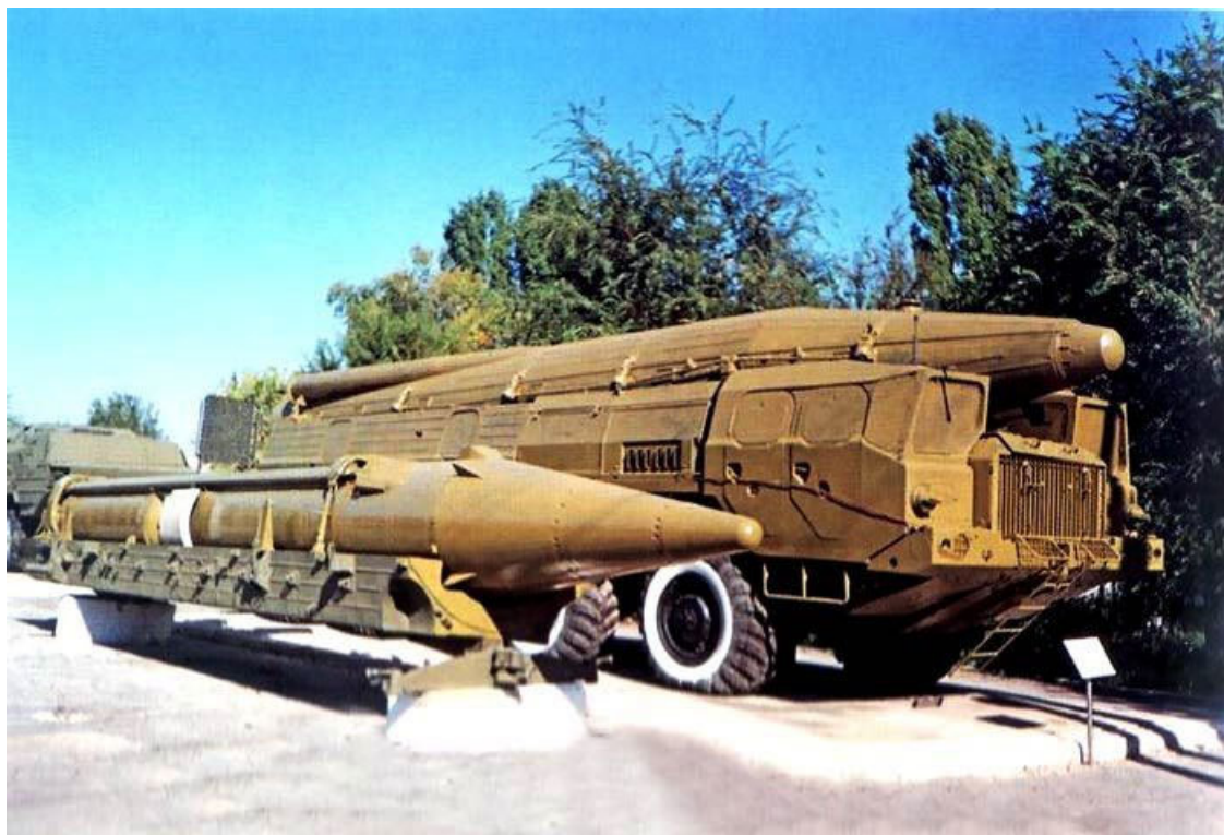
Ракета 9М76Б, часть контейнера для хранения и транспортировки и СПУ комплекса 9К76 «Темп-С» ( http://www.young-science.ru )
