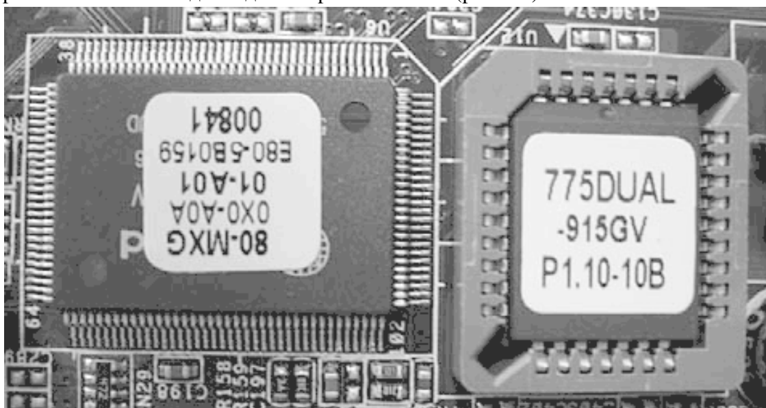
Рис. 3.4. Микросхема BIOS в дублирующем исполнении
