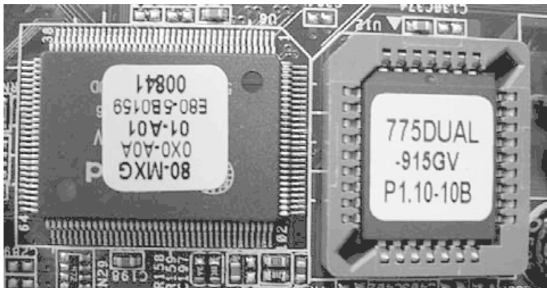
Рис. 3.4. Микросхема BIOS в дублирующем исполнении
