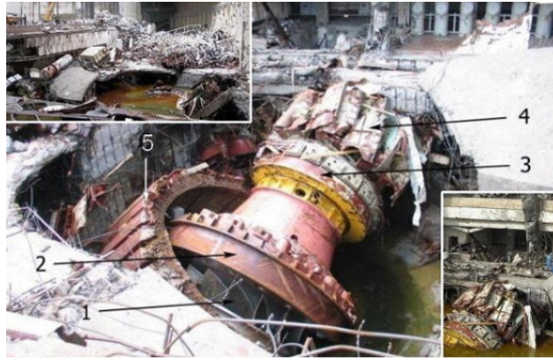
Рис. 4. Аварийное разрушение гидроагрегата №2 1-рабочее колесо турбины; 2- крышка турбины; 3- ванна подпятника; 4- спицы ротора генератора; 5- обод ротора генератора
