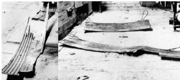
Рис. 14. Аварийное разрушение неподвижного кольца
