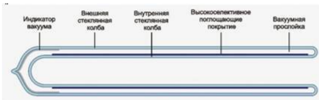
Рис.13 Продольный разрез коаксиальной вакуумной трубки
