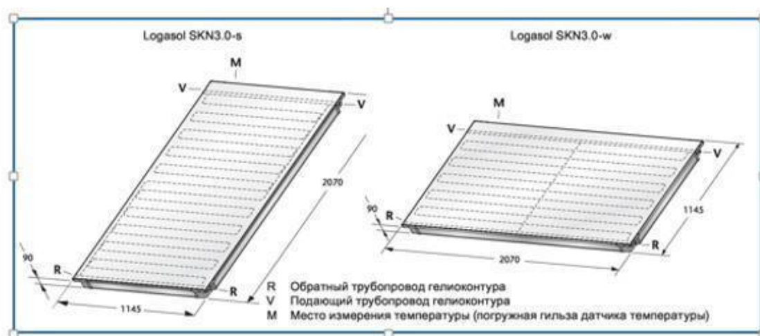
Рис.12 Гелиоколлектор SKN3.0-S–вертикальный, SKN3.0-w- горизонтальный
