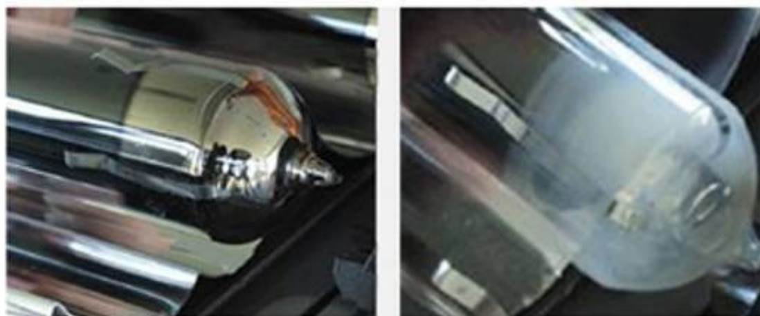
Рис.14 Зеркальный слой – индикатор вакуума
