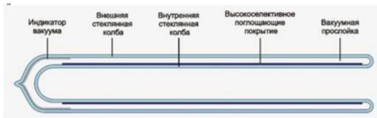
Рис.13 Продольный разрез коаксиальной вакуумной трубки
