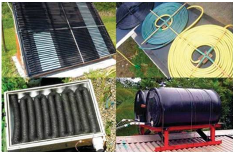
Рис.1 Некоторые примеры исполнения простейших тепловых солнечных коллекторов
