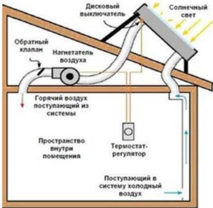
Рис.6 Воздушный гелиоколлектор для крыши
