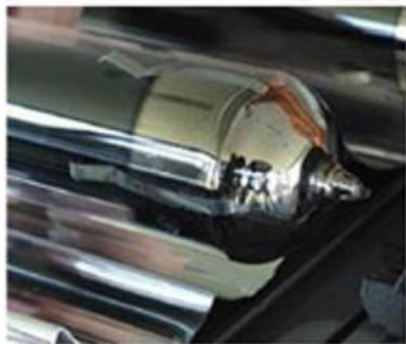
Рис.14 Зеркальный слой – индикатор вакуума
