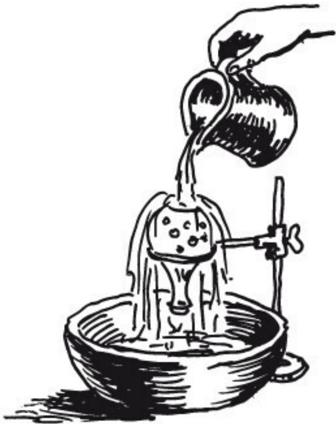
Закипание воды в колбе, обливаемой холодной водой
