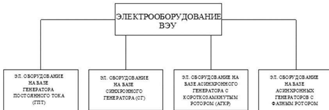
Рис.23 Классификация ВЭУ по типу применяемой электрической машины
