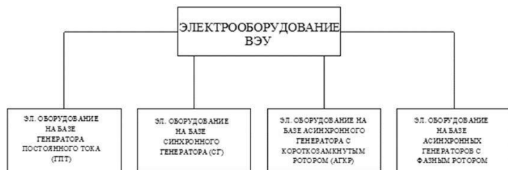
Рис.23 Классификация ВЭУ по типу применяемой электрической машины
