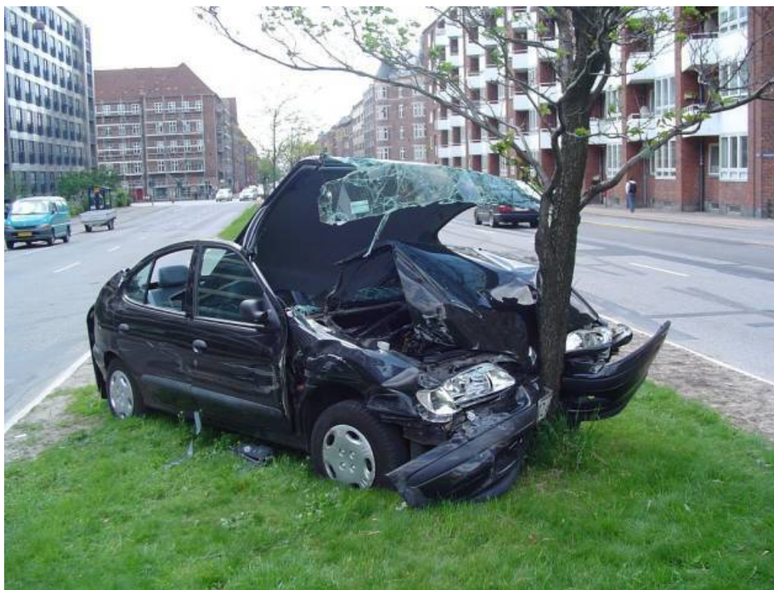
Пример повреждений автомобиля при лобовом столкновении
