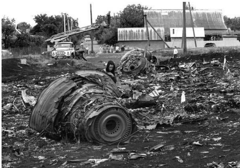
Рис. 17. Детали двигателя «Rolls-Royce Trent 800» без вала, скрепляющего их воедино (на снимке по центру)
