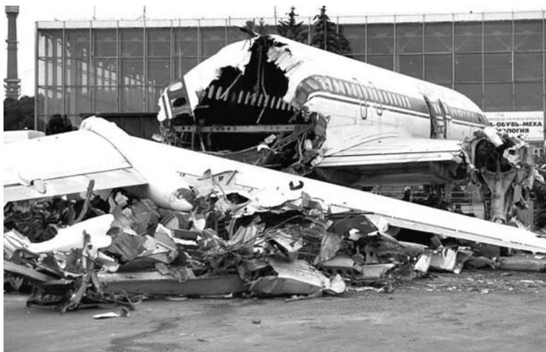
Рис. 29. Разрезка и разрывание самолета на металлолом гидрожницами
