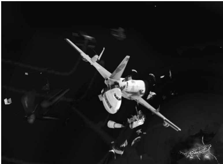
Рис. 22. Реконструкция разрушений «Боинга 747» над Локерби
