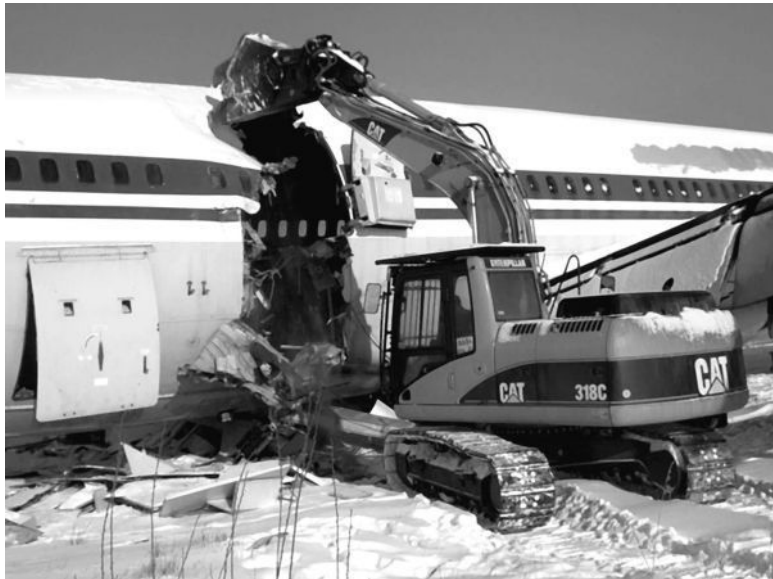
Рис. 26. Машина для разделки корпусов самолетов
