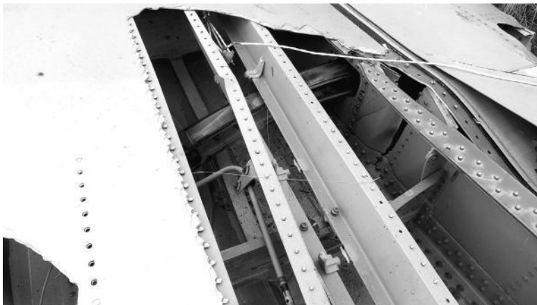
Рис. 34. Повреждения несущей плоскости
