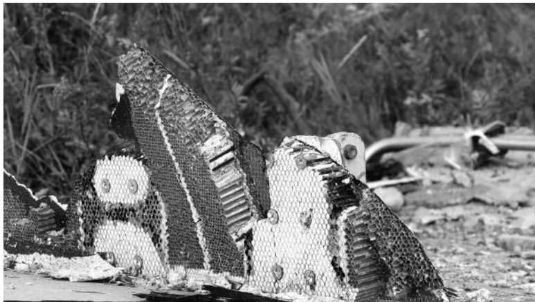
Рис. 35. Фрагмент с внутренней термоизолирующей и несущей обшивкой самолета
