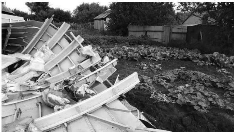
Рис. 40. Ровный обрез шпангоутов
